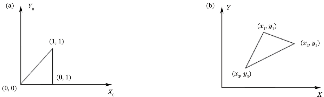
图1 二维坐标关系图。(a)基元三角形坐标系 X_0Y_0 ; (b)任意三角形坐标系 XY
