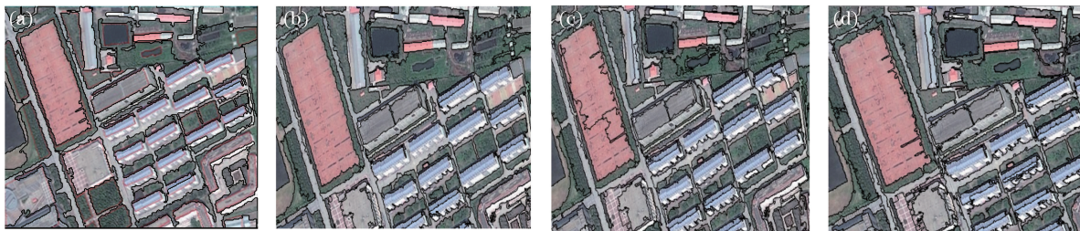
图 2 不同分割方法的结果。(a)添加噪声影像所提方法的分割结果;(b)没有添加噪声影像所提方法的分割结果; (c)文献[6]方法的分割结果;(d)文献[7]方法的分割结果
