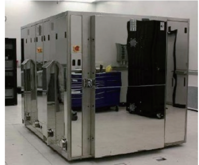
图 6 诺格公司报道的输出 15 kW 的全固态板条激光系统实物图 [50]
