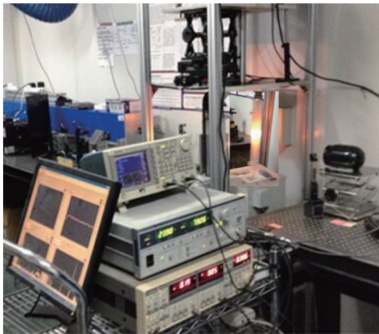
图 5 采用 TDLAS 技术测量单颗粒煤球热解过程的照片
