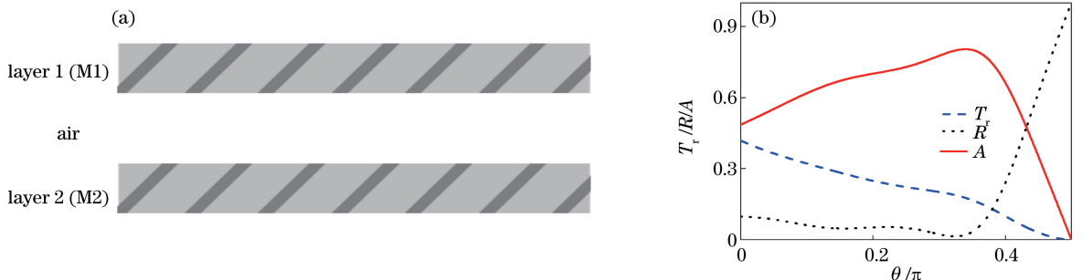
图5 两层级联结构的(a)示意图和(b)透射谱、反射谱、吸收谱
