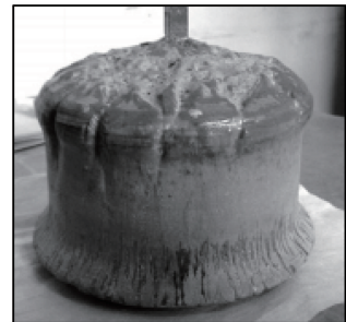
图 2 摩尔分数相等的 LiCl 与 KCl 的混合剂作为液封剂时生长的 GaSb 多晶
