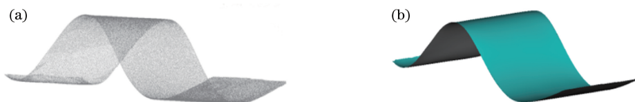
图 2 曲面零件的(a)点云数据和(b) STL 模型
