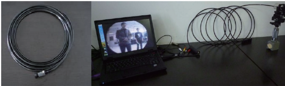
图 24 (a) 聚合物传像光纤;(b) 监视系统样机 [32]
