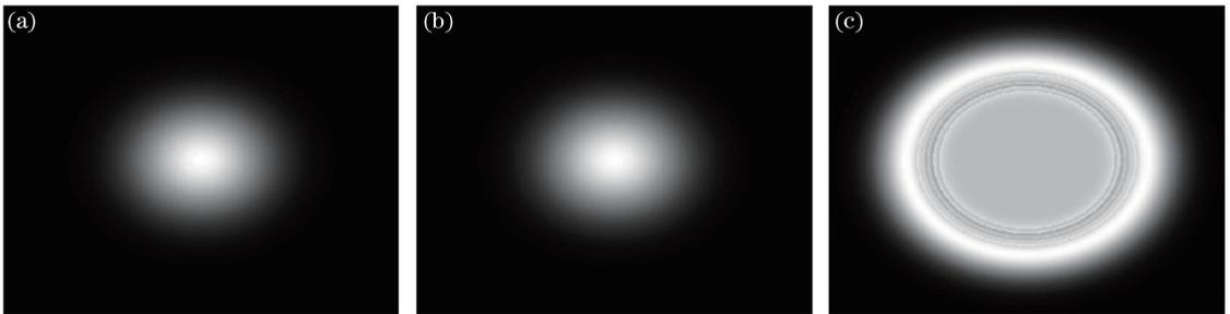
图 4 不同高度的光斑分布图。(a)初始光斑;(b)40 km 处光斑;(c)1 km 处光斑
