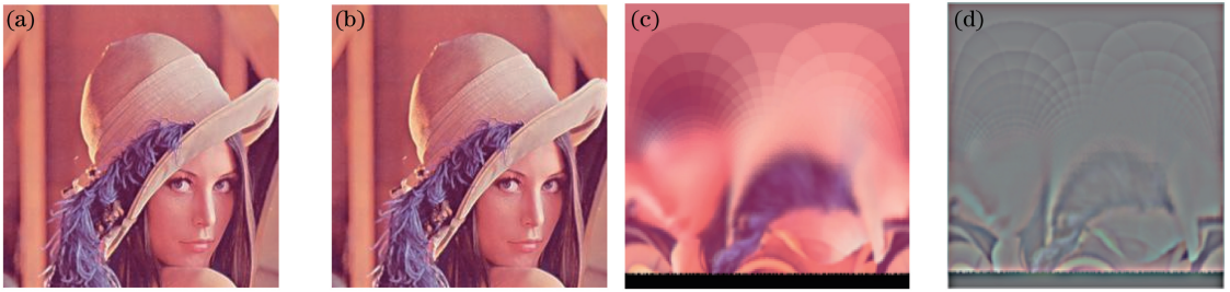
图3 二次图像的生成及其 Gabor 滤波器处理。(a)初始图像；(b)双线性插值的平滑处理； (c)对数极坐标变换的二次图像；(d) Gabor 滤波器的过滤结果
