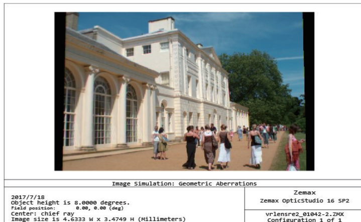
图 11 自由曲面棱镜头盔显示器光学系统成像模拟
