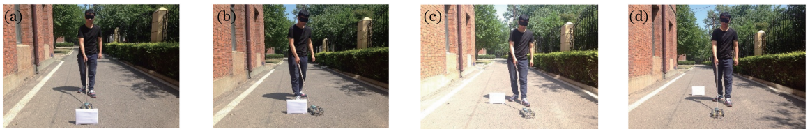
图 11 导盲机器人障碍识别实验。(a)发现障碍;(b)改变行进方向;(c)保持行进方向;(d)成功躲开障碍
