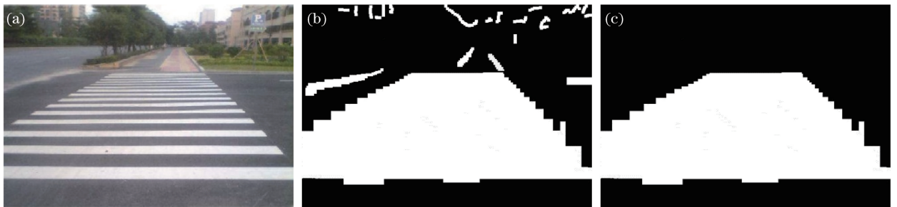
图5 (a)斑马线原始图像;(b)双极系数图像;(c)形态学处理后的图像
