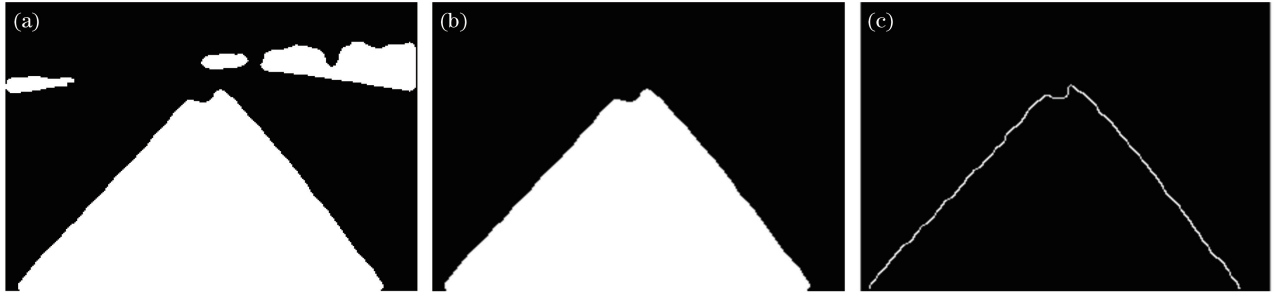
图8 盲道特征提取结果。(a)形态学处理;(b)面积阈值滤波;(c)边缘提取
