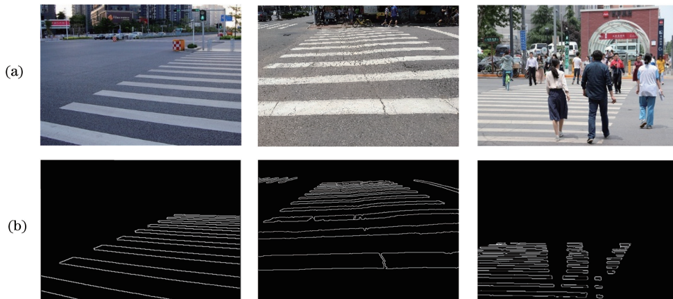
图 12 斑马线识别效果。(a)原图;(b)识别图
