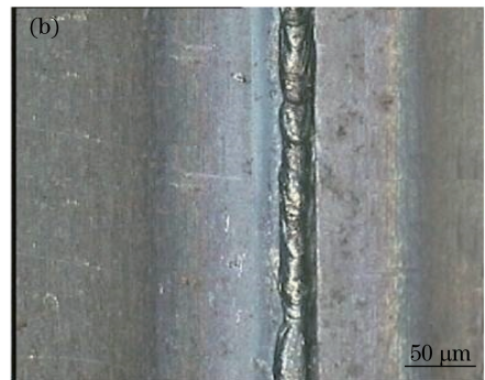
图 12 理想焊缝的宏观图像。(a)正面;(b)背面
