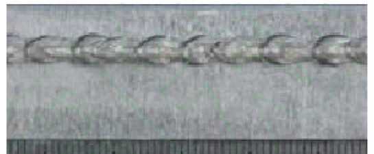
图 6 激光填丝焊“大滴”过渡下的焊缝表面成形 [36]
