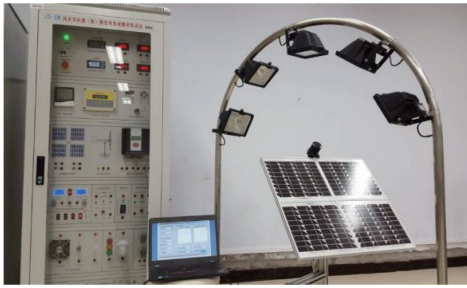
图 6 光伏组件发电特性测量系统
