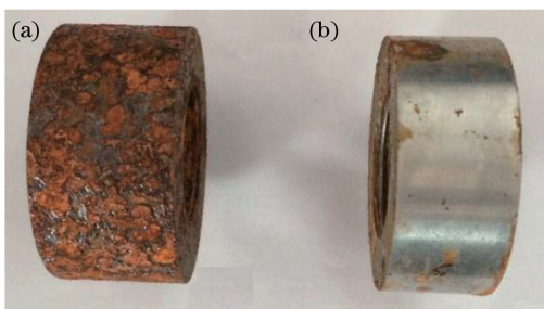
图 9 中性盐雾实验结果图。(a)粉末 A;(b)粉末 B
