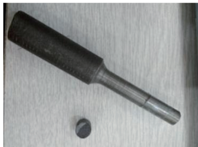
图 5 被拉断的激光熔覆拉伸棒
