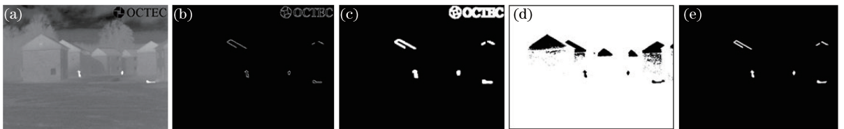
图 1 红外目标提取图像 1。(a)红外源图像;(b) Canny 算子提取的边缘图像;(c)形态膨胀后的 Canny 边缘;(d) Otsu 阈值分割图像;(e)图(c)和图(d)的融合图像
