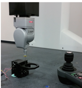
图 3 调焦机构的传动精度实验
