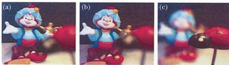
图 4 实验结果。(a)固定焦距透镜;(b)液体透镜聚焦在 50 cm 处;(c)液体透镜聚焦在 2 cm 处
