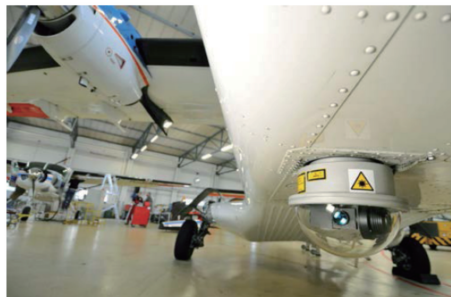
图2 安装在Do-228飞机上的激光通信载荷
