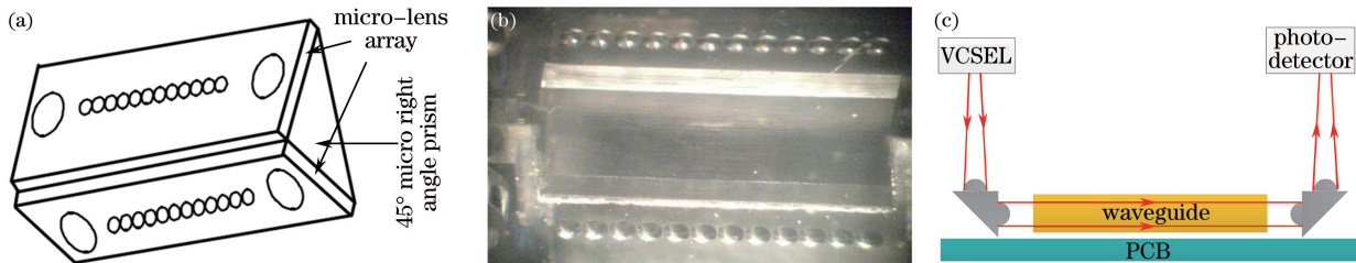
图 19 国防科学技术大学微型转向元件。(a) 结构示意图；(b) 实物图；(c) 光电印制板互连示意图
