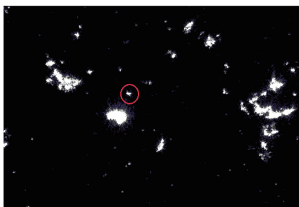
图 11 s 偏振光 45^\circ 时的亚表面损伤图
