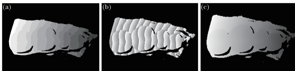
图5 (a) 格雷码解码条纹图像; (b) 牙模折叠相位; (c) 绝对相位分布
