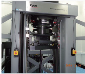
图 11 参考面面形检测光路
