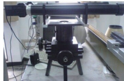
图3 线轴/线包热膨胀系数测试系统
