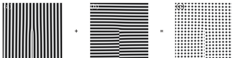
图2 分数阶复合叉形光栅制备原理。(a) l=0.5 垂直位错;(b) l=0.5 横向位错;(c) 整数阶 l=0.5 叠加叉形光栅
