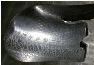
图9 鼠标模具型腔的激光蚀纹
