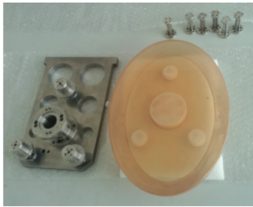
图10 反射镜及支撑结构件
