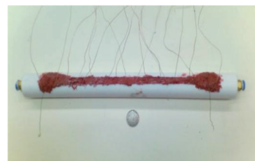
图3 1 mm圆管换热实验段图
