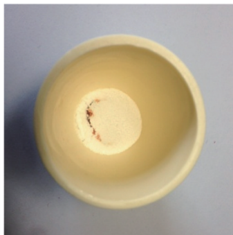
图3 样品 S1-2 热处理后坩埚中的红色物质 Fig.3 Red material in the crucible after heat treatment of S1-2
