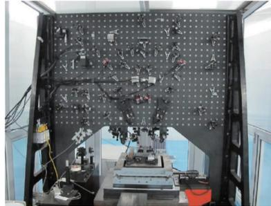
图3 中国科学院长春光学精密机械与物理研究所研制的扫描干涉场曝光系统原理样机图
