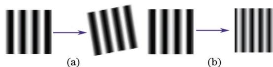
图10 利用分光镜测量周期方法的局限性。(a) 条纹方向发生变化; (b) 条纹周期大小发生变化
