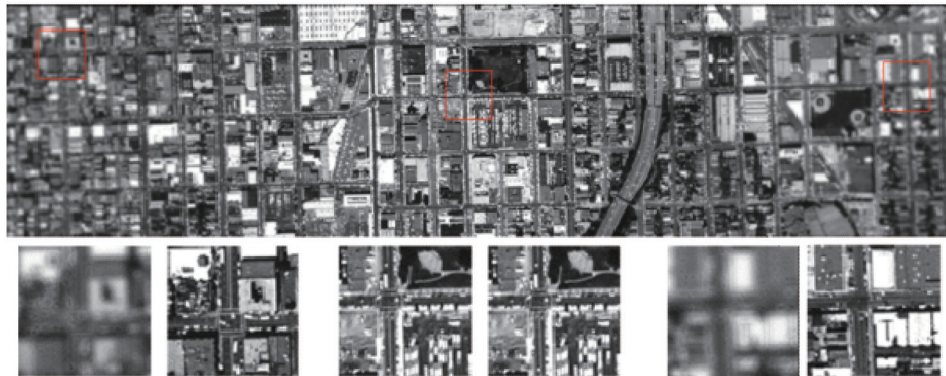
图18 GEOeye-1卫星三个焦面位置对应的图像(0.8waves对应相机移动120步)
