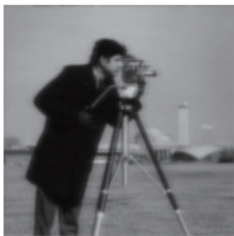
图9 倾斜量 2a\theta_x = 0.71\lambda 时所成的像
