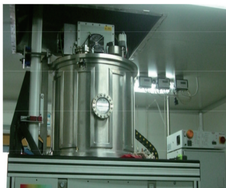
图 1 射频等离子体增强化学气相沉积设备
