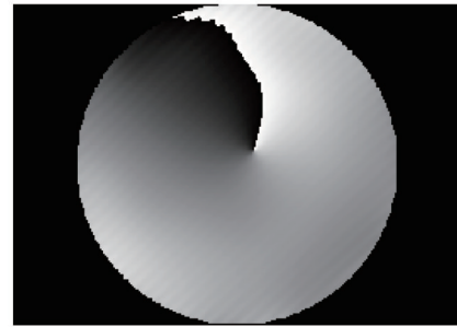
图8 处理后光场振幅分布迭代70次恢复的相位分布 Fig.8 Recovery phase distribution of 70 iterations for later amplitude
