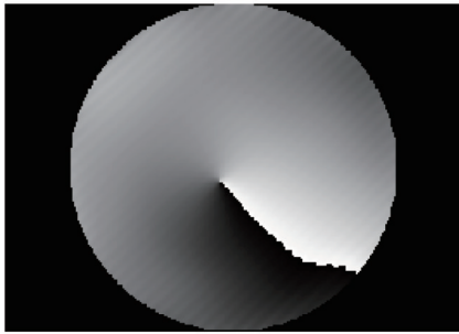
图7 处理后光场振幅分布迭代50次恢复的相位分布 Fig.7 Recovery phase distribution of 50 iterations for later amplitude
