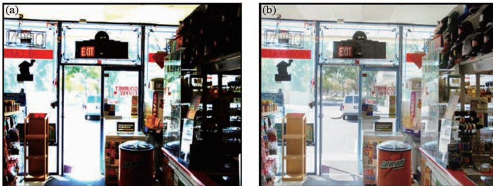
图3 Pixim公司各像素点曝光时间不同以实现HDRI。(a)常规图像;(b)HDRI
