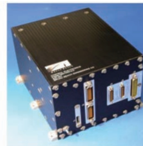
图4 飞行件控制器电子学模块
