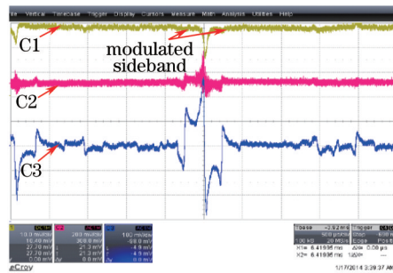
图3 实验测得的780 nm光与F-P腔作用的色散型误差谱线
