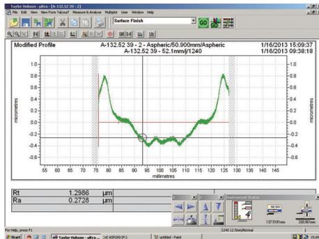
图6 精抛光中第一次修正补偿检测结果
