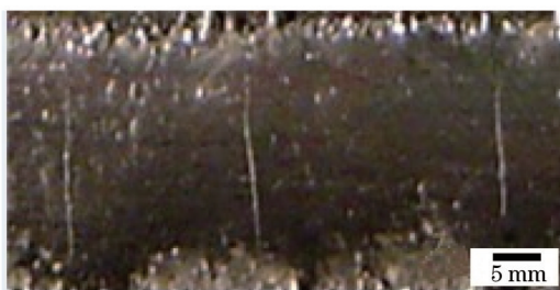
图8 单向送粉单向扫描产生的裂纹形状
