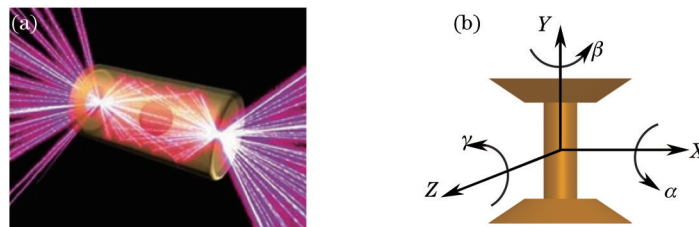
图2 (a) 直径为2 mm的柱腔靶; (b) 喇叭口柱腔靶示意图
