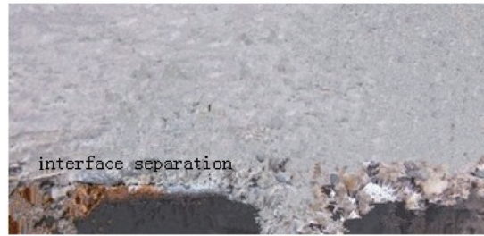
图5 混凝土板与钢梁的交界面分离示意图
