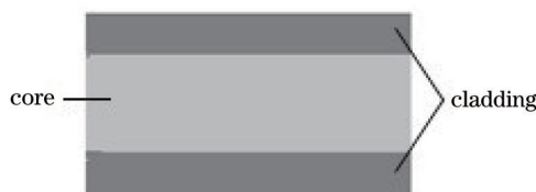
图1 固-液界面微流体光波导结构
