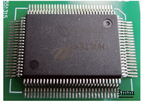
图3 SnAg3.0Cu0.5钎料连续激光软钎焊后的QFP-100器件外观
