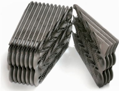
图 3 SLM 技术制造热交换器(TCT Magazine)
