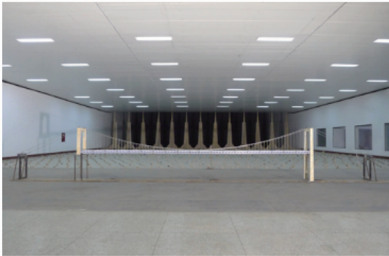
图 4 全桥气动弹性模型构造图
