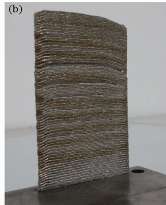
图 14 激光熔覆成形件实物图。(a)堆积件,尺寸约为 85\text{ mm}\times 35\text{ mm}\times 15\text{ mm} ; (b)薄壁件,尺寸约为 50\text{ mm}\times 5\text{ mm}\times 85\text{ mm}
