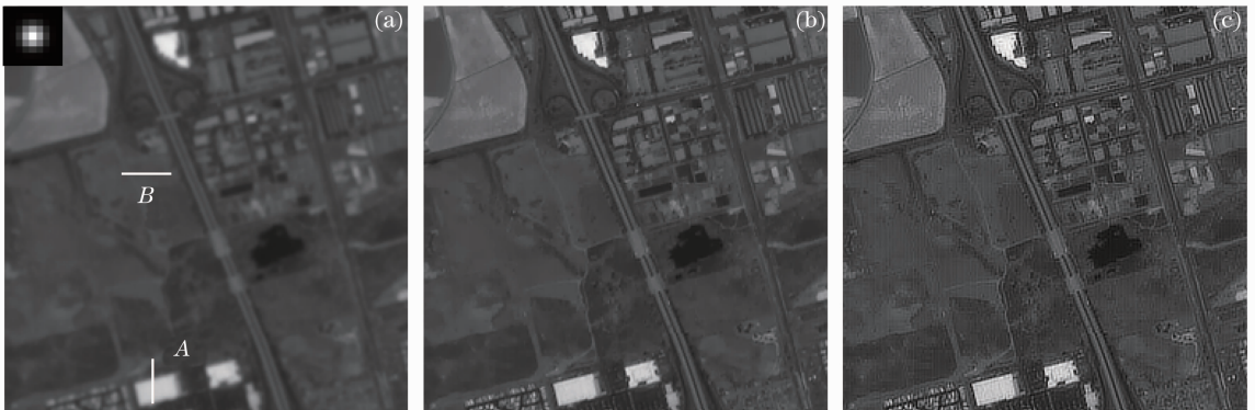
图 2 遥感图像与去模糊处理后的图像。(a)原始数据;(b)受限全变差方法去模糊效果;(c)有约束最小二乘法去模糊效果
