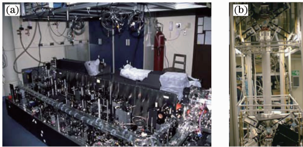
图 4 早期的冷原子导航传感器。(a) 原子陀螺仪 [17] ; (b) 冷原子重力梯度仪 [19]
